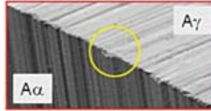
Aşındırma işleminden önceki Mikroyapı
